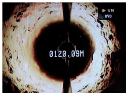
Pozos con ranura incrustada. Se reducen los niveles. Es momento de un mantenimiento!
